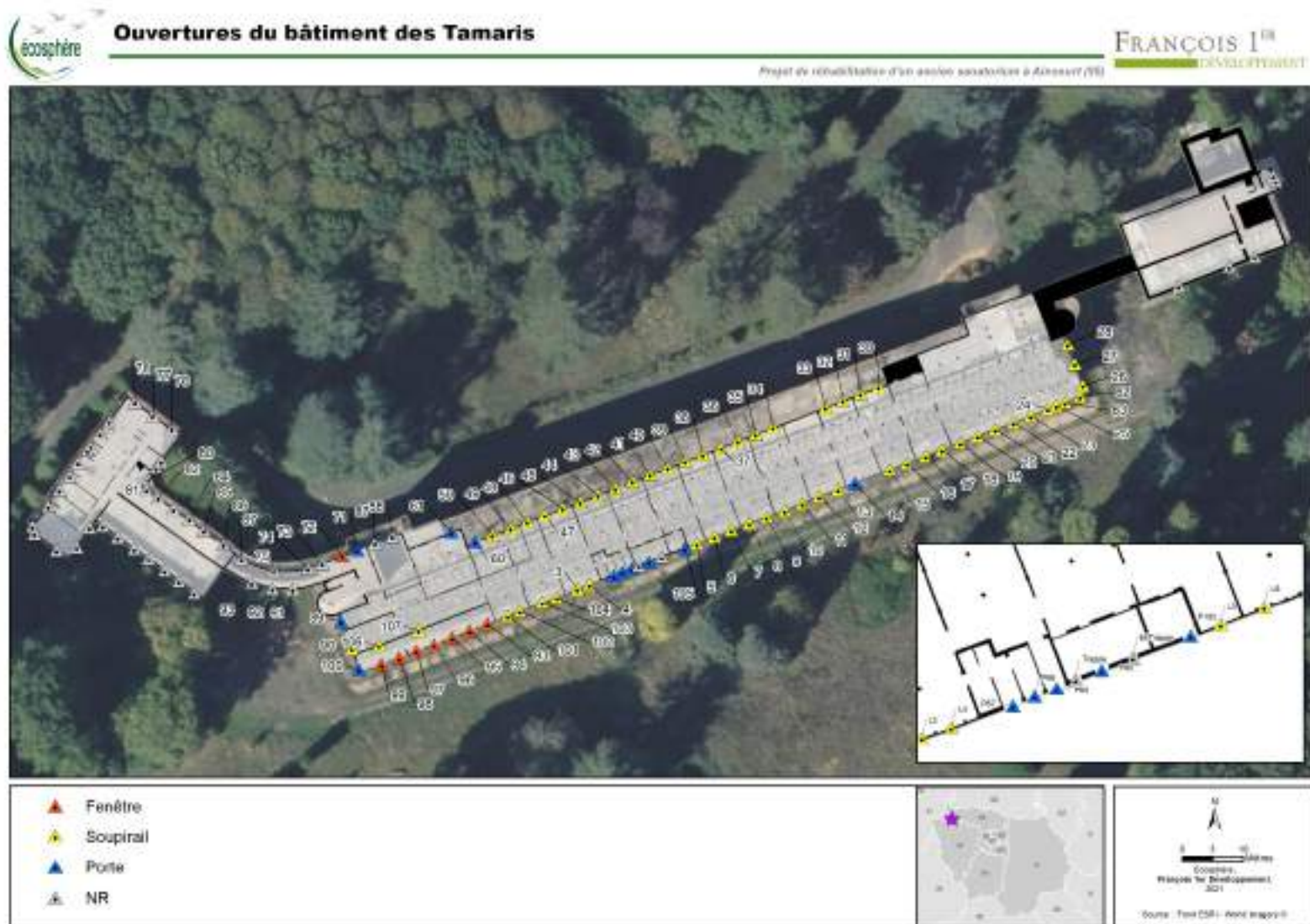
Carte 10. Ouvertures au niveau du vide-sanitaire du bâtiment des Tamaris
