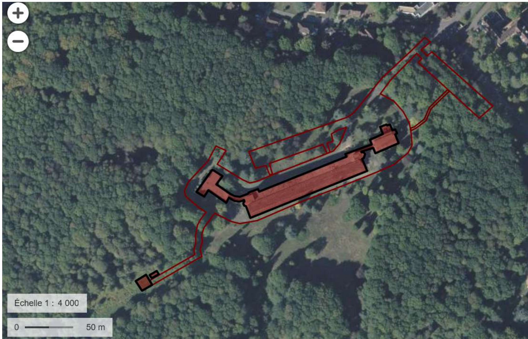
Figuration des emprises « chantier » (en rouge détourné noir : les bâtiments rénovés ou à construire, en rouge : le périmètre subissant des modifications structurelles de revêtement, le reste du parc n'est concerné que par des travaux paysagers légers) – Ecosphère/Géoportail
