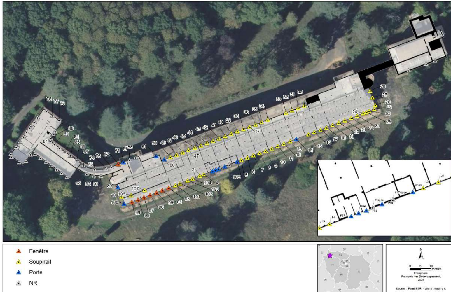
Carte 10. Ouvertures au niveau du vide-sanitaire du bâtiment des Tamaris
